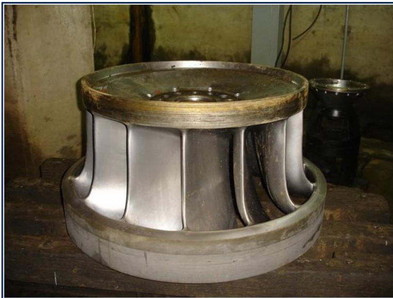
FOTO 2: Vista del plato superior de la turbina.
