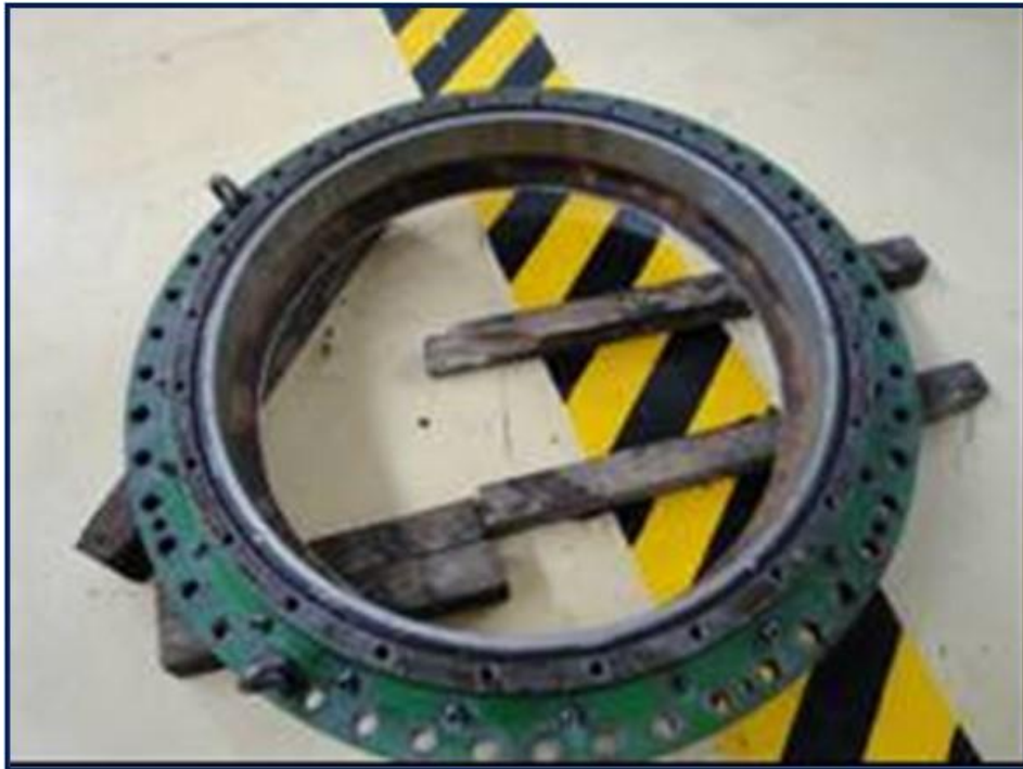
FOTO 3: Vista del plato inferior de la turbina.
